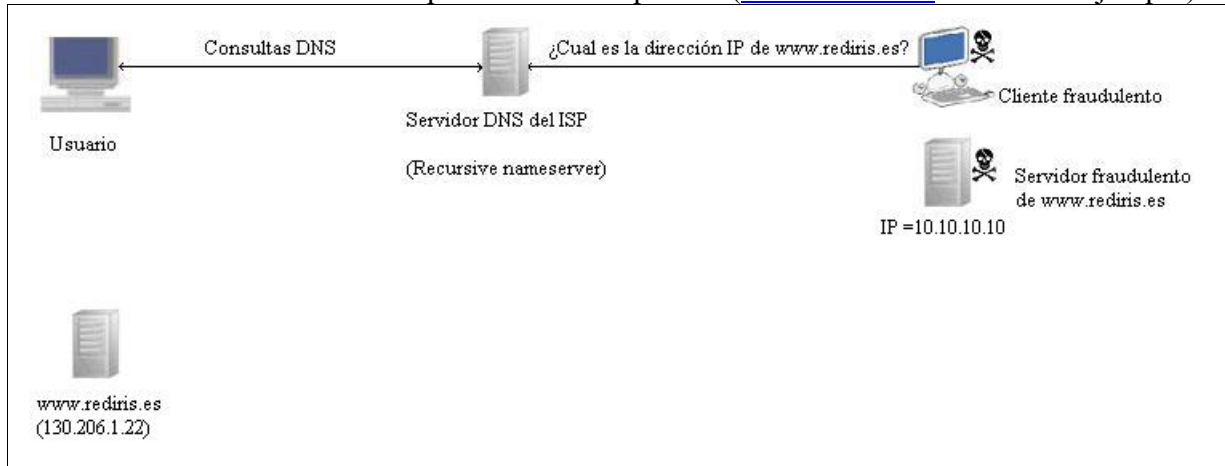
Fig. - 10: Solicitud de resolución de nombre por parte de un cliente fraudulento.
